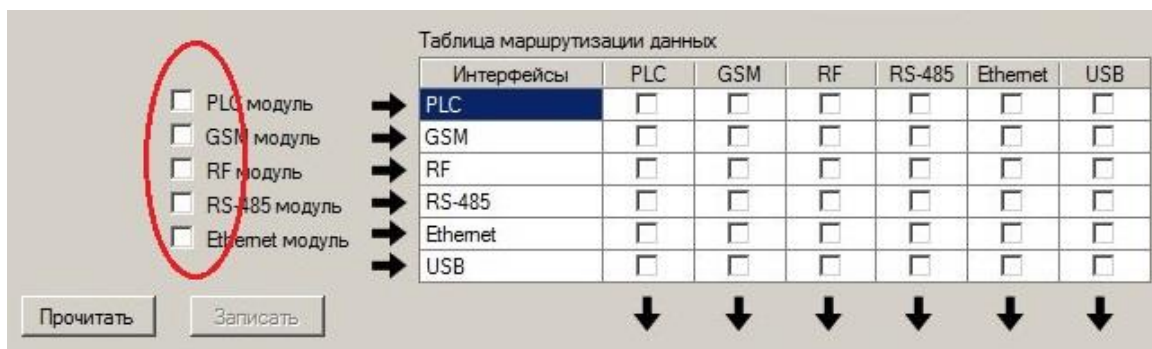
Рисунок 8 – Столбец возможных модулей связи, таблица маршрутизации
